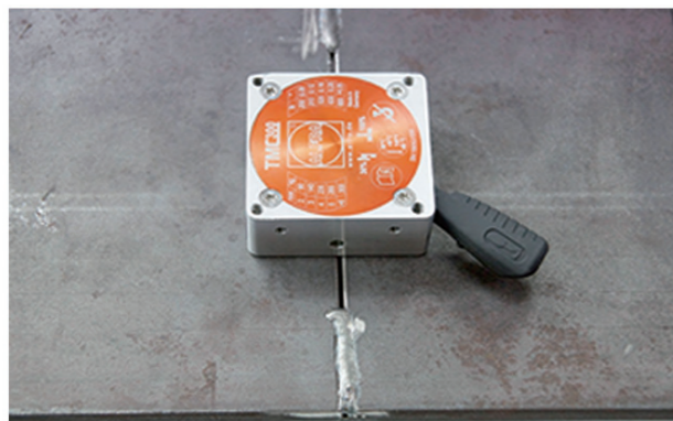
リフティングマグネット本体から 15mm離れたところから溶接可能
